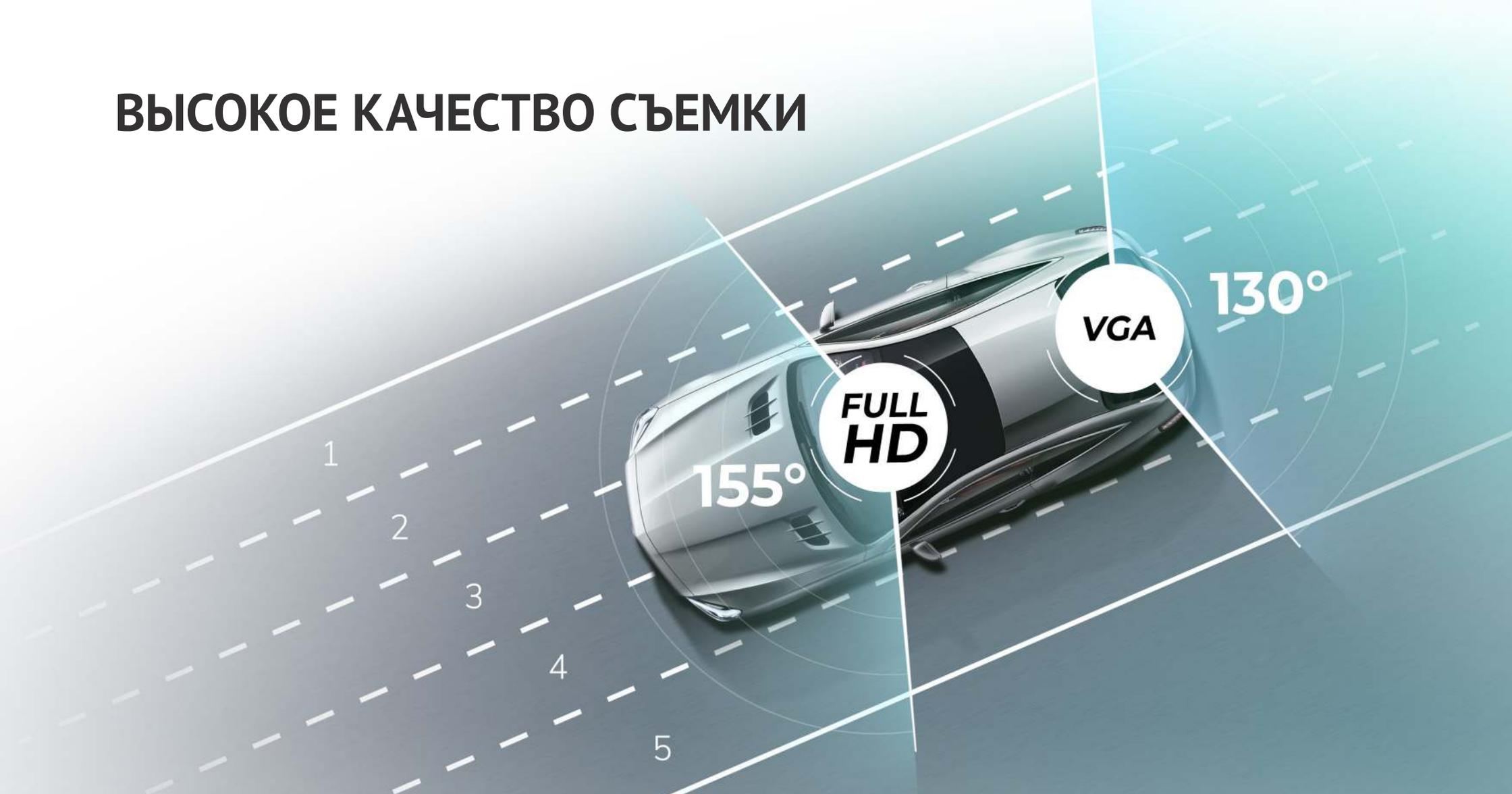
Мощный процессор **Jieli JL5601** поддерживает детализированную фронтальную съемку в разрешении **Full HD**. Камера заднего вида **iBOX RearCam Discovery** записывает видео в разрешении **VGA**. Обработка видео ведется с применением кодека **H.264**, что позволяет хранить значительно больше видеофайлов на **SD** карте. Благодаря углу обзора фронтальной камеры **155°** в кадр попадает пять полос дорожного полотна и обочина. Угол обзора камеры заднего вида – **130°**.
