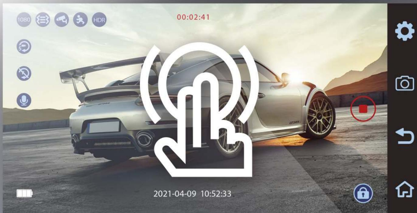
Яркий сенсорный IPS дисплей высокого разрешения с диагональю 4,8” отлично читается под любым углом. Он обеспечивает удобное и интуитивно понятное управление видеорегистратором. Сенсор имеет идеальный отклик во всём диапазоне рабочих температур – от -35°С до +55°С. Самые основные функции продублированы на кнопках в нижней панели устройства, что помогает управлять регистратором еще более оперативно.
