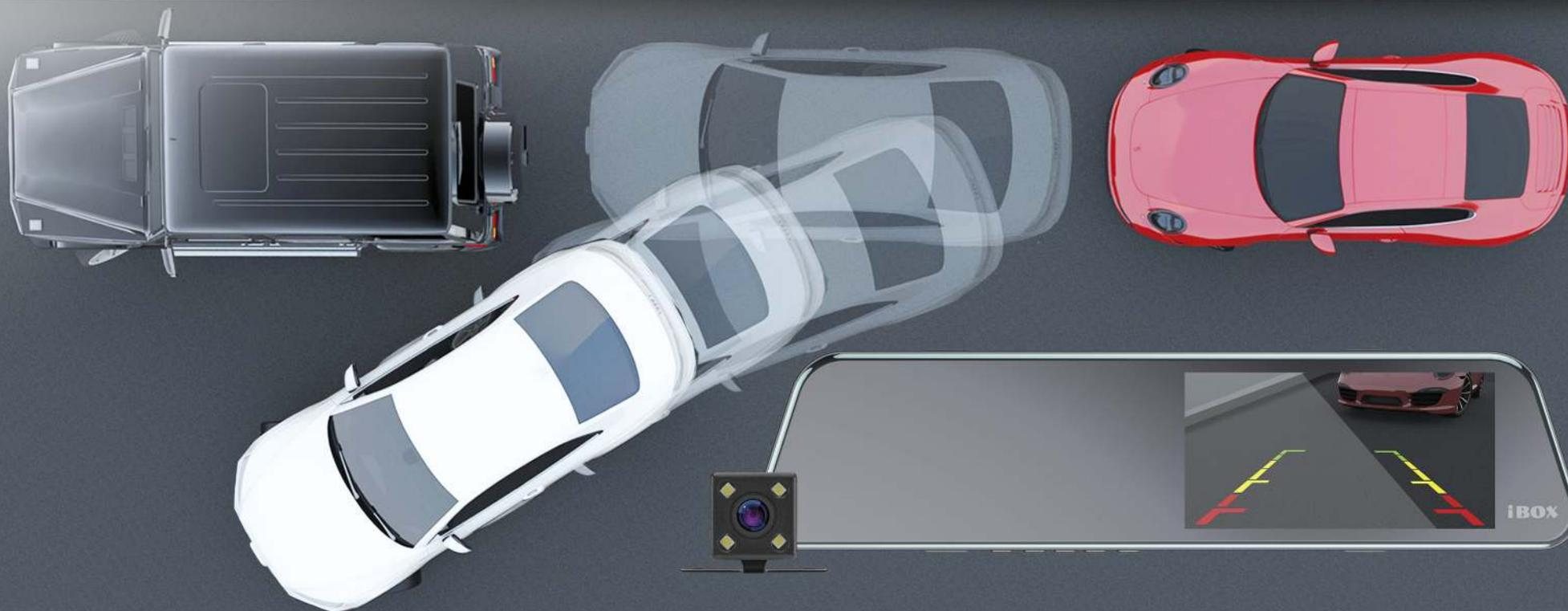
Устройство имеет возможность подключения камеры заднего вида **iBOX RearCam Discovery**. При этом осуществляется одновременная запись с двух камер совместно с функцией «Помощь при движении назад». При движении автомобиля назад на дисплее устройства автоматически включается видео с задней камеры. Таким образом, обеспечивается полный контроль дорожной ситуации, делая вождение более безопасным и комфортным.
